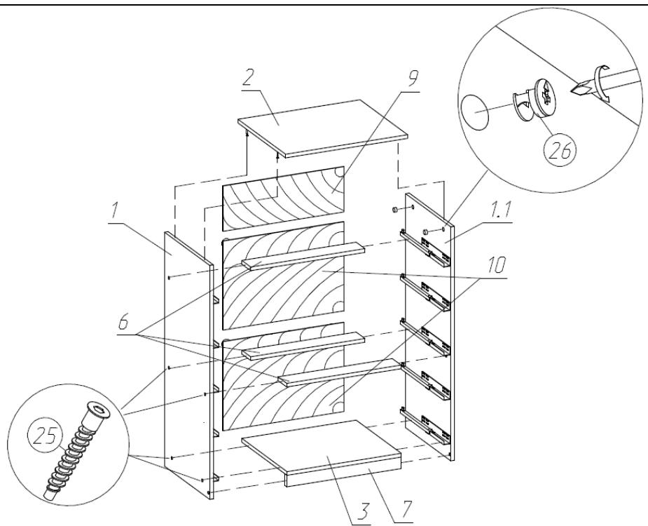
Схема соединения скрепками (поз.67)
