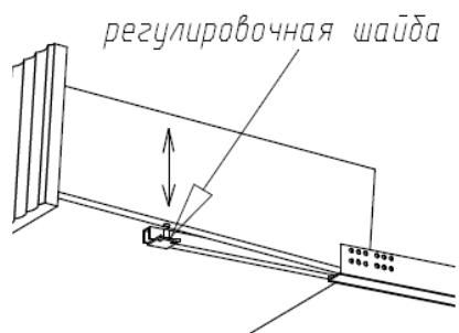
4. При желании, закрепите ящик к направляющим саморезами. ВАЖНО! Во избежание повреждения боковины ящика рекомендуется предварительно просверлить отверстие для для вкручивания самореза.
